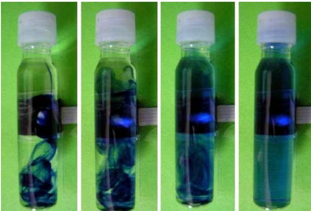
Demonstration des Mischens zweier Flüssigkeiten mit vollständig gefüllter, verschließbarer Küvette und Magnetrührer mit Rührstäbchen - eine notwendige Modifikation für das spätere Probenhandling
